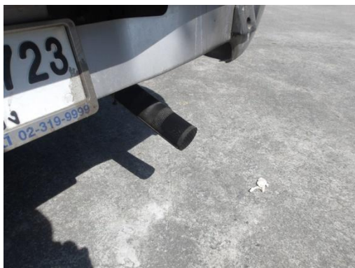
รูปที่ 3-34 อุปกรณ์ในการป้องกันไม่ให้เกิดประกายไฟจากท่อไอเสีย
