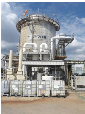
รูปที่ 3-47 Sulfur Scrubber
